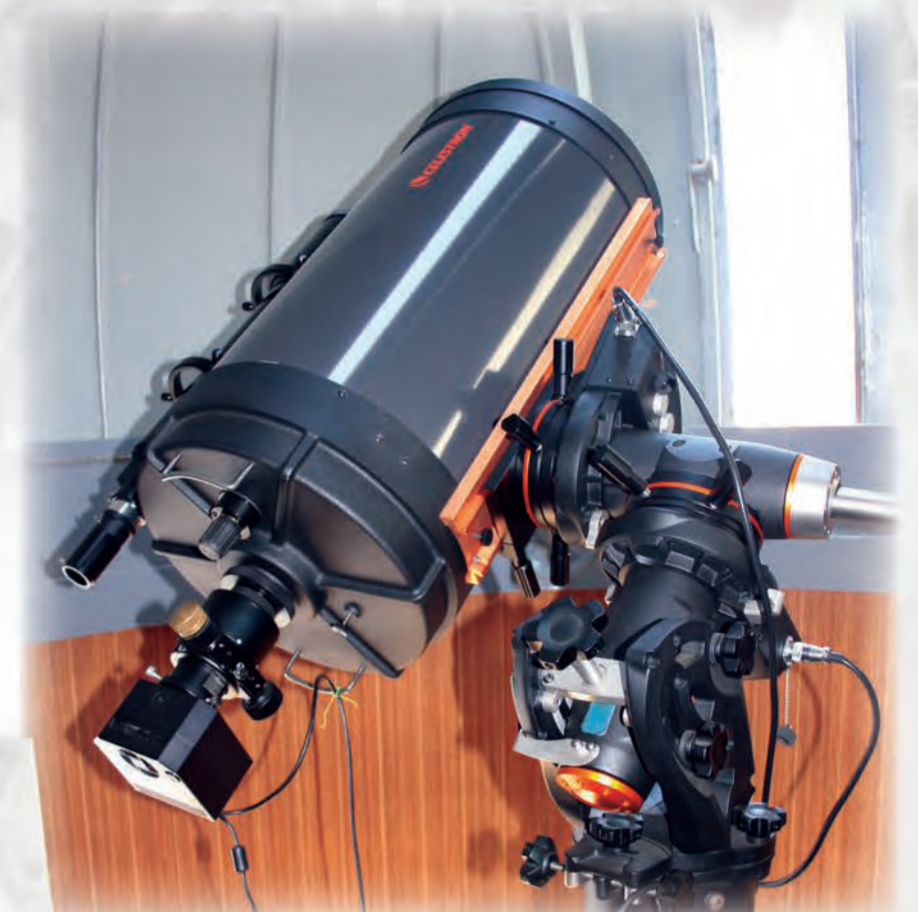
Zrcadlový dalekohled o průměru zrcadla 355 mm slouží zejména pro CCD fotometrii proměnných hvězd.
