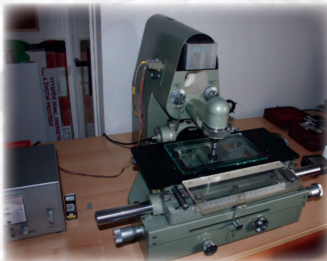
Modernizovaný irisový mikrofotometr sloužil k proměňování negativů proměnných hvězd.
