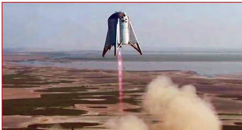
Obrázek 4 – Testovací zařízení Starhopper při skoku do výšky 150 metrů.
