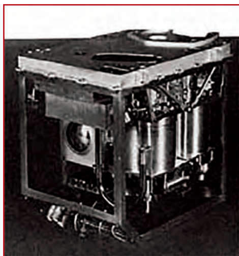
Obr. 4. Biologické vybavení Vikingu (a) fotografie Ezell et Ezell (1984) [9], (b) schéma NASA/Bizony (1997) [10].
