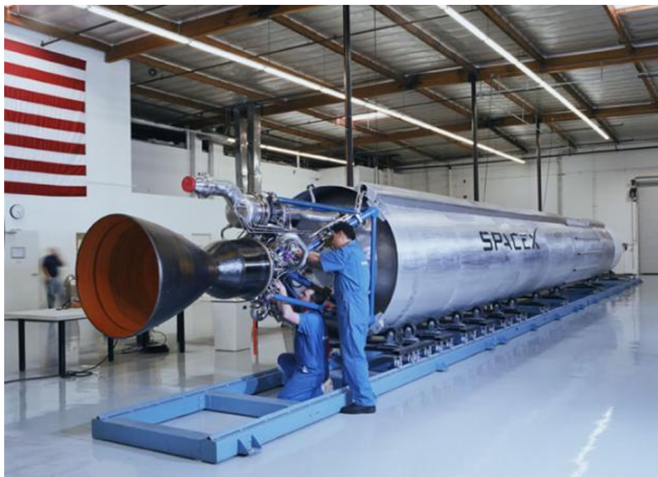
Obr. 2 Příprava kosmické rakety Falcon 1 s raketovým motorem Merlin. Zdroj: Space X (Wikipedia)
