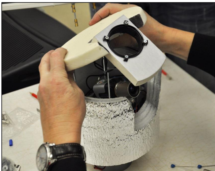
Snímek č. 03 – Citlivá kamera pro snímání meteorů bude umístěna ve speciální gondole, která ji bude částečně chránit před nepříznivými podmínkami ve stratosféře.
