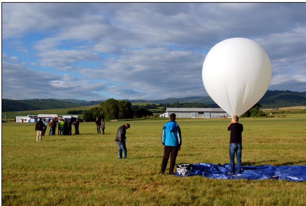
Snímek č. 03 – Napouštění stratosférického balónu heliem pro let do stratosféry. Snímek je z letu SDS 04 realizovaného v červnu roku 2014. Zdroj: STRATO-NANOBIOLAB
