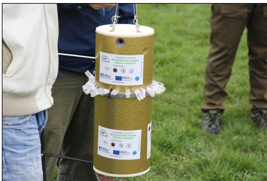
Snímek č. 04 – Pohled na sestavenou gondolu stratosférického balónu. Na povrchu jsou dobře patrné kyvety s lyofilizovanými bakteriemi a viry. Zdroj: STRATO-NANOBIOLAB
