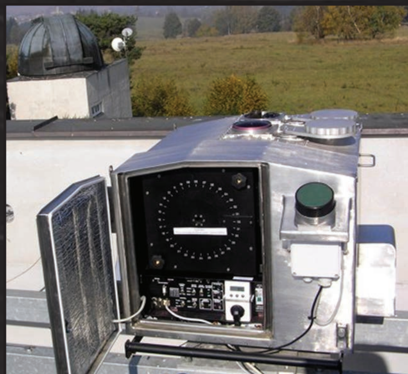
Moderní stanice Evropské bolidové sítě instalovaná v Kunžaku.
