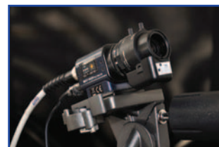
Citlivá televizní CCD kamera pro pozorování meteorů.
