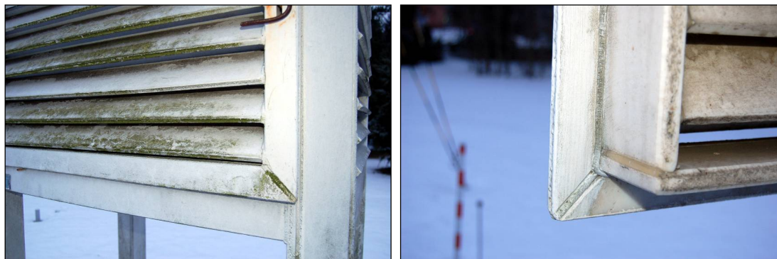
Obrázek č. 4 - současný stav povrchu meteorologické budky včetně detailu spoje.
