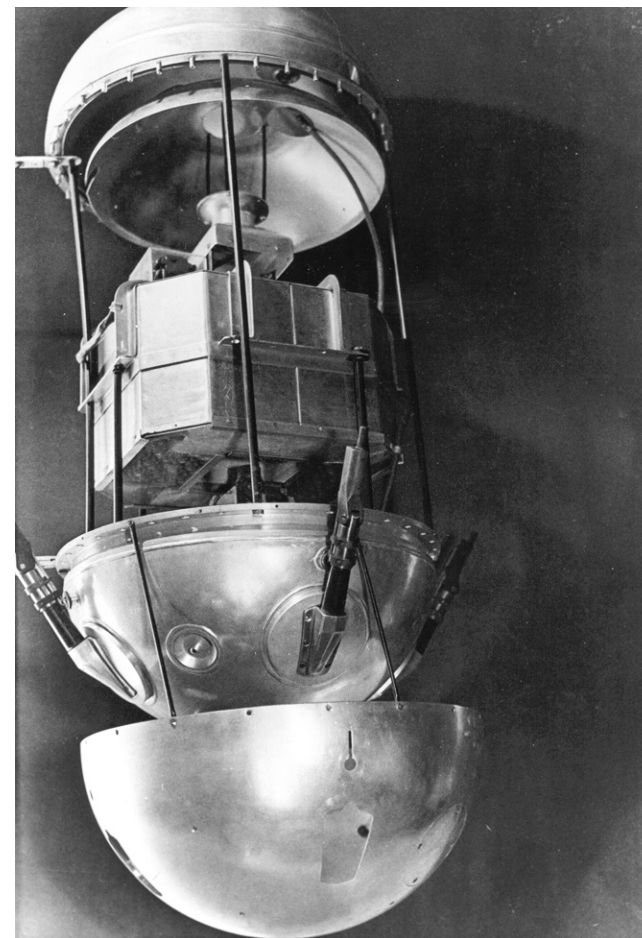
První umělá družice Země - Sputnik - v rozloženém stavu. Její start se uskutečnil 4. 10. 1957.
