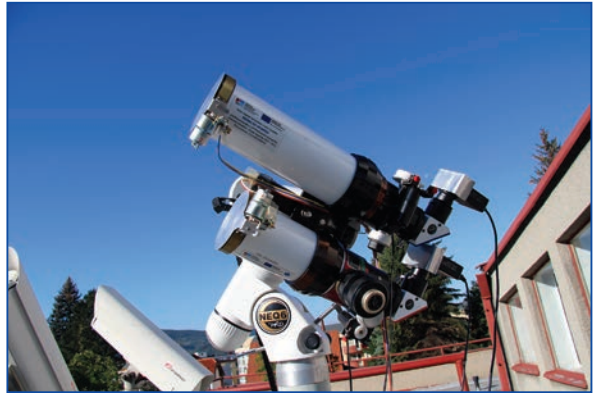
Přehledové dalekohledy pro celkové snímky Slunce ve spektrálních čarách vodíku a vápníku.
