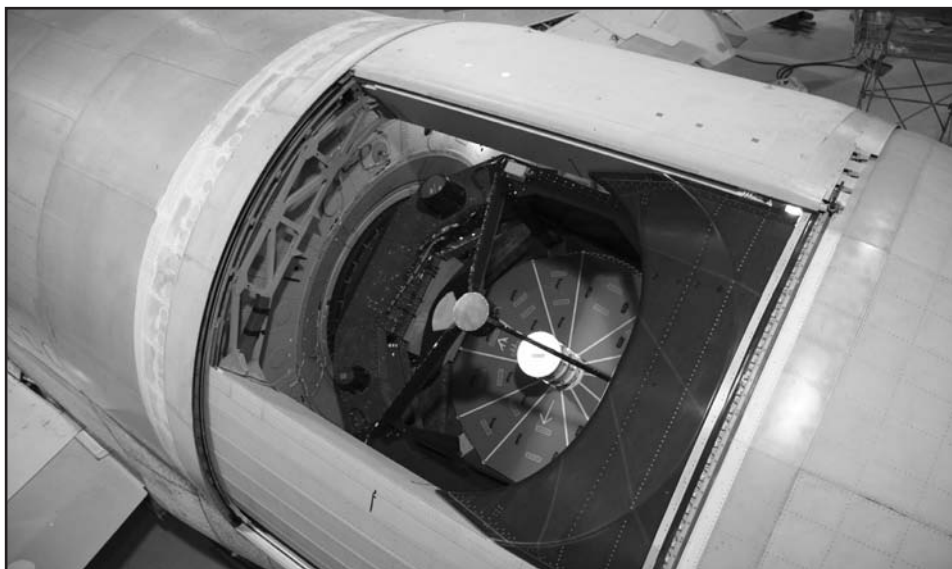
Umístění dalekohledu na palubě létající observatoře SOFIA
