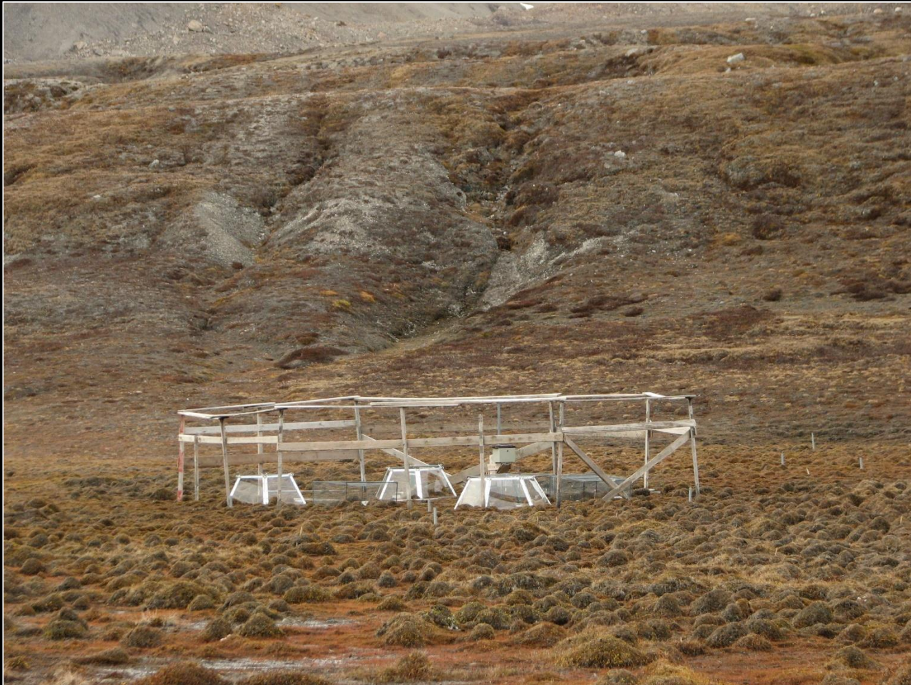
Komory pro simulaci mírného oteplení v Arktidě, Petuniabukta, Svalbard.
