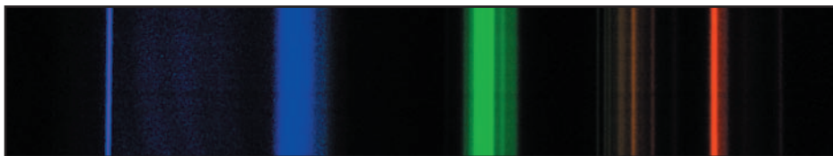
Ukázkový snímek spektra zářivky pořízeného přes dalekohled Celestron; jedná se o spektrum prvního řádu přes mřížku 200 vrypů na mm.
