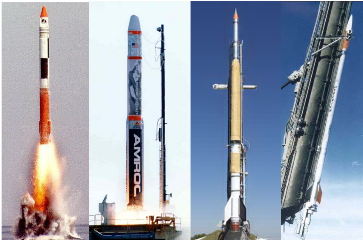
Obr. 3 Rakety poháněné HRM – zleva Dolphin, SET-1, HySR a Hyperion [5]
