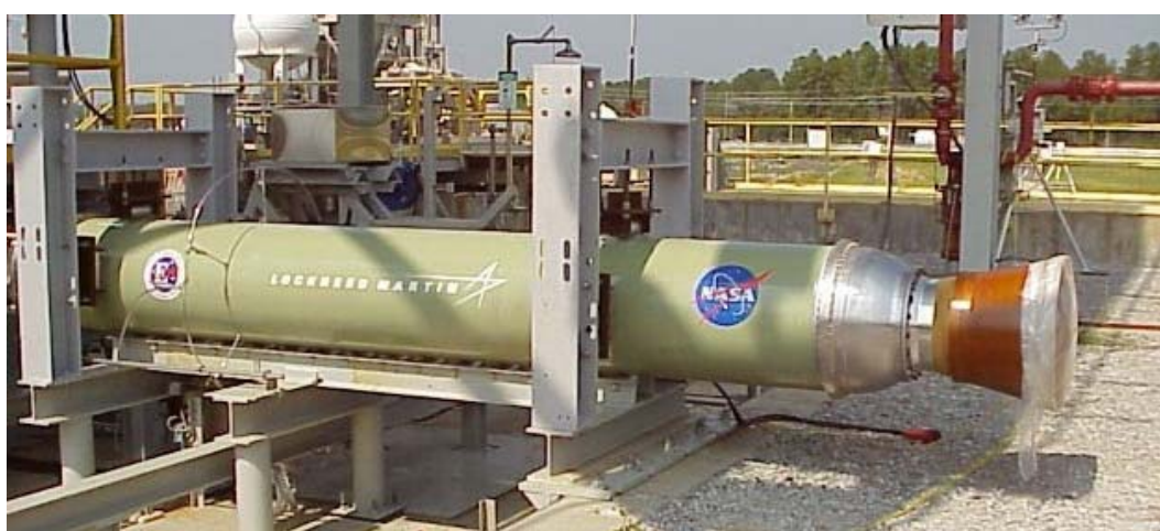
Obr.5 HRM sondážní rakety HySR na zkušební stoličce [5]
