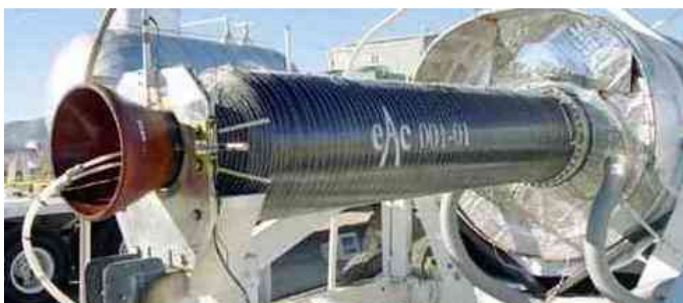
Obr.6 HRM raketoplánu SS1 při pozemních zkouškách [5] (eAc – environmental Aerospace company)
