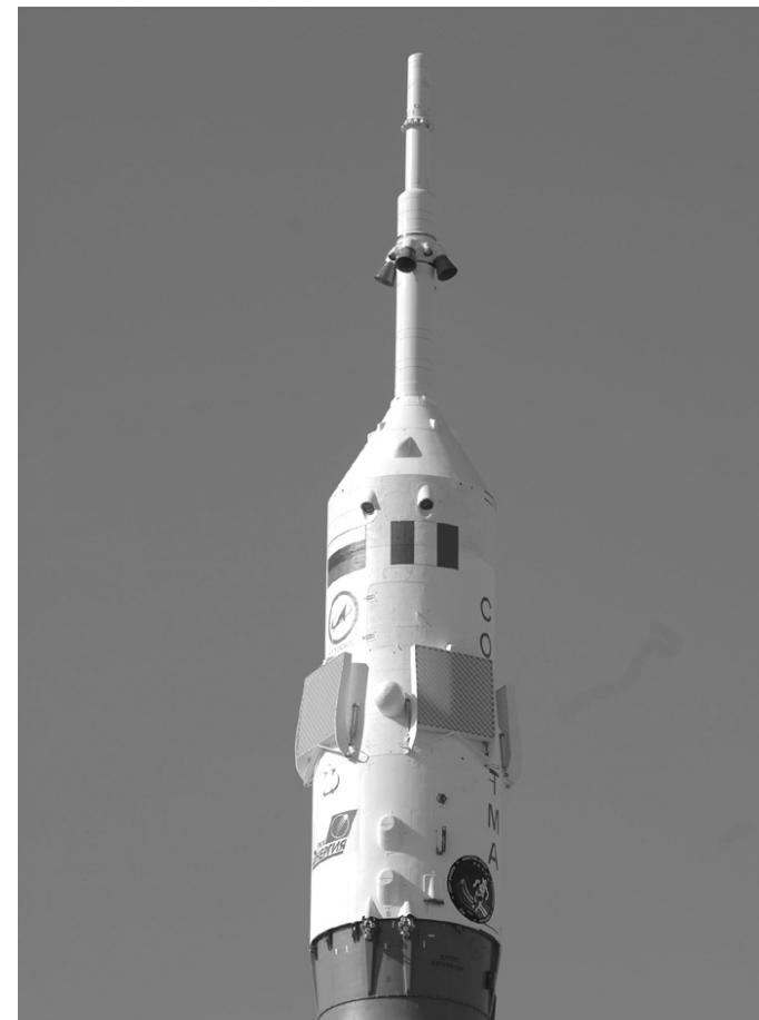
Kosmická loď Sojuz TMA-6 (pod aerodynamickým krytem) se záchranným systémem, připojená k nosné raketě Sojuz.
