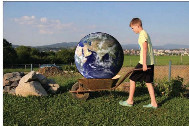
Stavební kolečka – jednoduchý stroj využívající principu páky a kola. I když jsme to na obrázku trochu přehnali, přesto tento jednoduchý stroj dokáže ušetřit hodně námahy, ale nikoliv práce.
