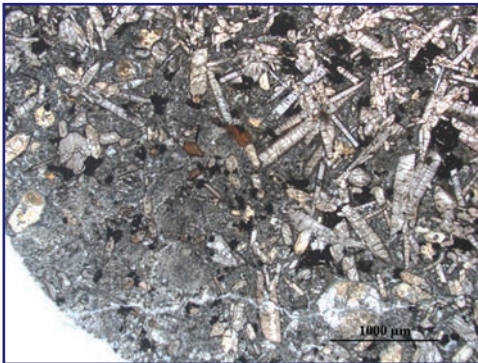
Ukázka výbrusu vulkanické horniny těšínitu pod mikroskopem (pohled v procházejícím polarizovaném světle, a – bez analyzátoru, b – s analyzátořem).
